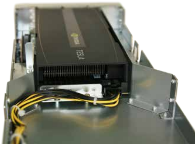
Изображение 7. Узел V205F с установленным ускорителем NVIDIA Tesla M2090.
