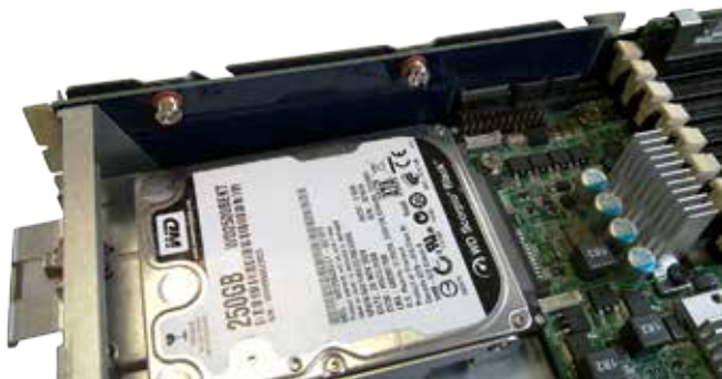
Изображение 6. Плата-разъем CardEdge, установленная на V205S.
