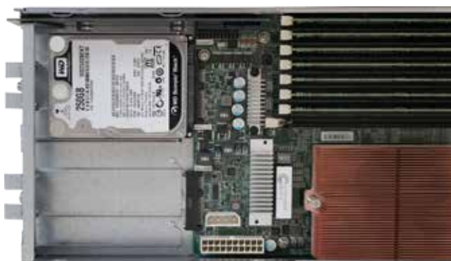
Изображение 12. Узел V205S с дисками холодной замены формата 2.5 дюйма.
