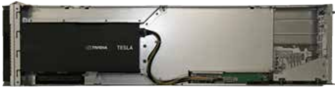
Изображение 4. Вычислительный модуль двойной толщины V205F с ускорителем NVIDIA Tesla M2090 (вид сверху, без верхней панели)
